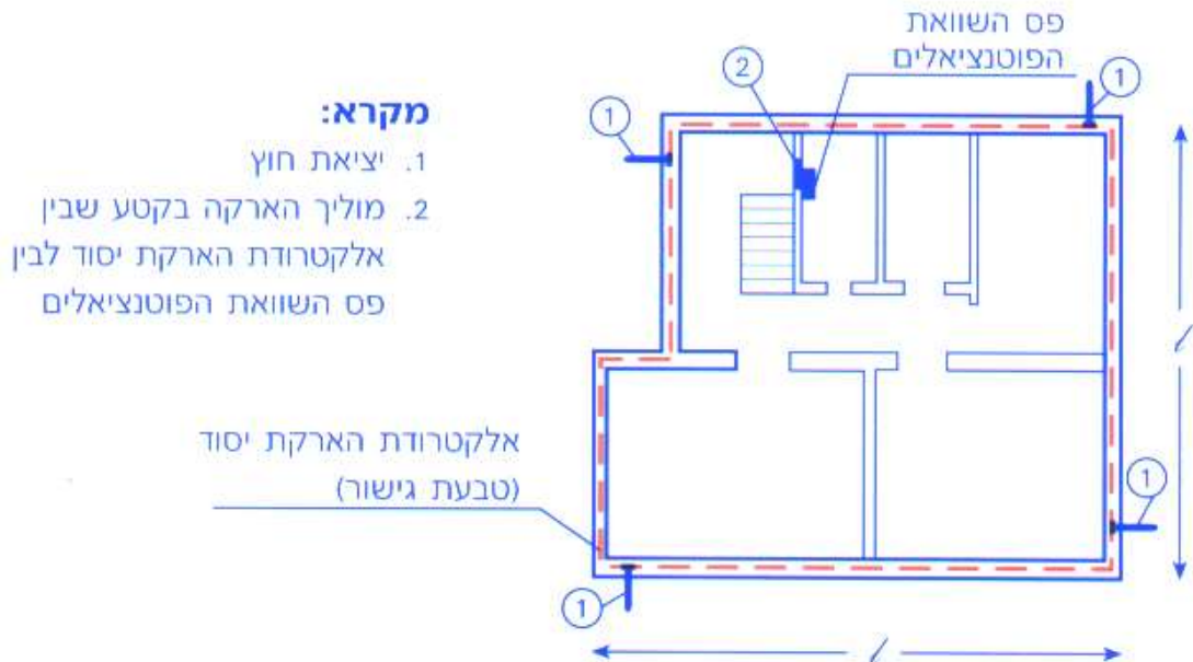
איור 1: תרשים עקרוני של הארקות יסוד בבניין בודד
